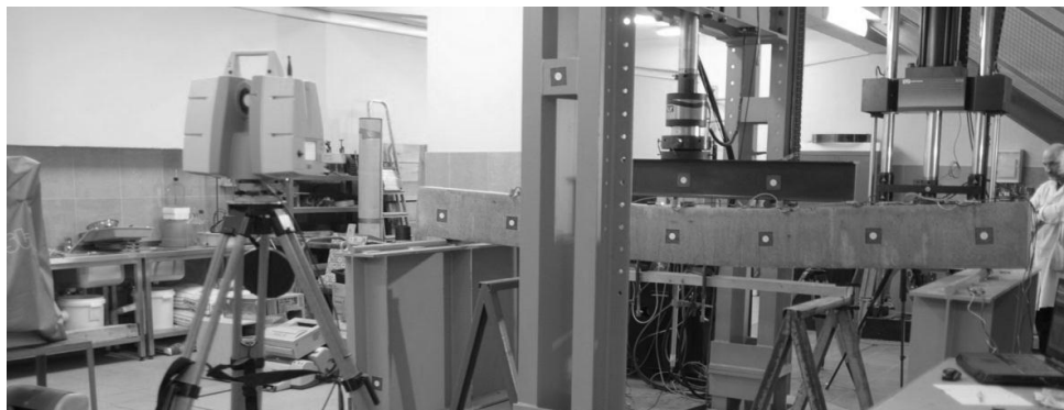
Rys. 7. Stanowisko badawcze z pozycją skanera laserowego
