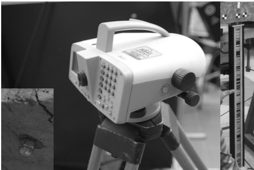
Rys. 5. Punkt pomiarowy, niwelator precyzyjny DNA 03 wraz z krótką łąką kodową
