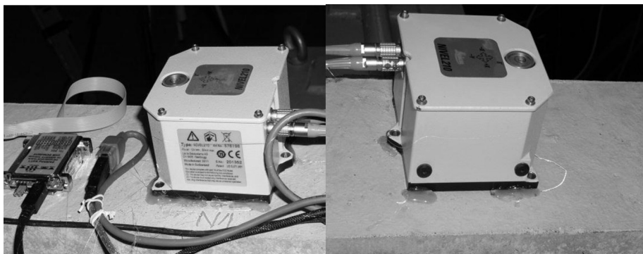
Rys. 9. Pochyłomierze umieszczone na belkowym elemencie konstrukcyjnym podczas badań laboratoryjnych
