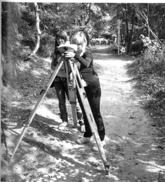
Rys. 3. W drodze na przełęcz pomiędzy Wielkim a Małym Szczelińcem. Pomiar niwelatorem Leica DNA03
