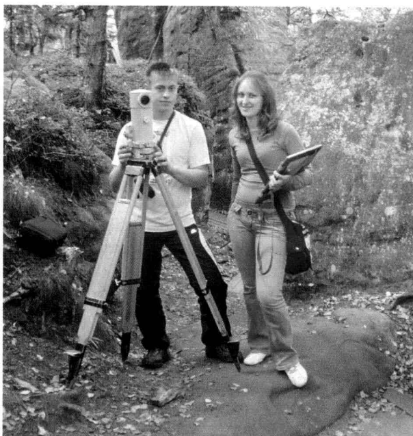
Rys. 4. Pomiary w partiach krawędziowych masywu Szczelińca Wielkiego. Pomiar niwelatorem Ni007
