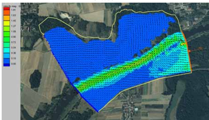
Rys. 4. Obszary prędkości przepływu wody wraz z wektorami prędkości dla rzędnej zwierciadła wody na wyjściu 102.50 m
