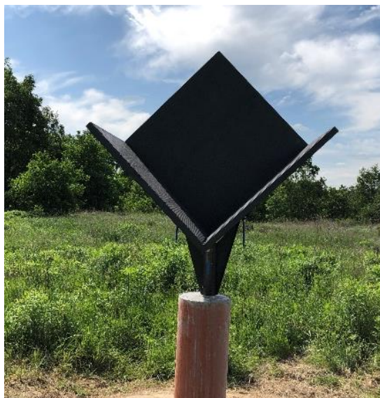
Reflektor do satelitarnej interferometrii radarowej zainstalowany przez IGiG UPWr. na terenie Górnego Śląska
