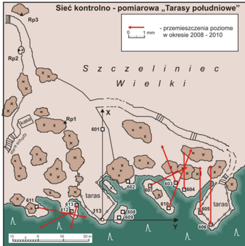
Ryc. 7. Rezultaty przemieszczeń poziomych punktów na tarasach południowych
