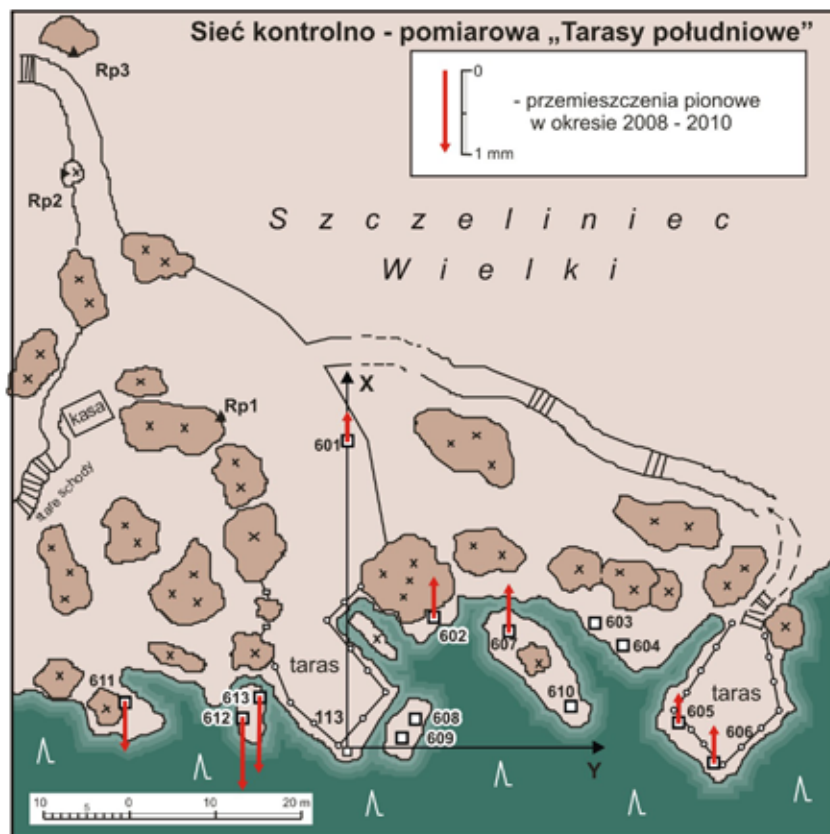
Ryc. 8. Przemieszczenia pionowe punktów na tarasach południowych
