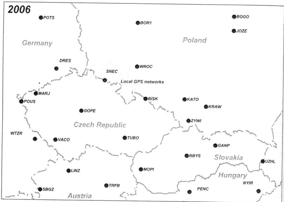
Rys. 1. Stacje permanentne EPN leżące w bezpośrednim sąsiedztwie sieci lokalnych
