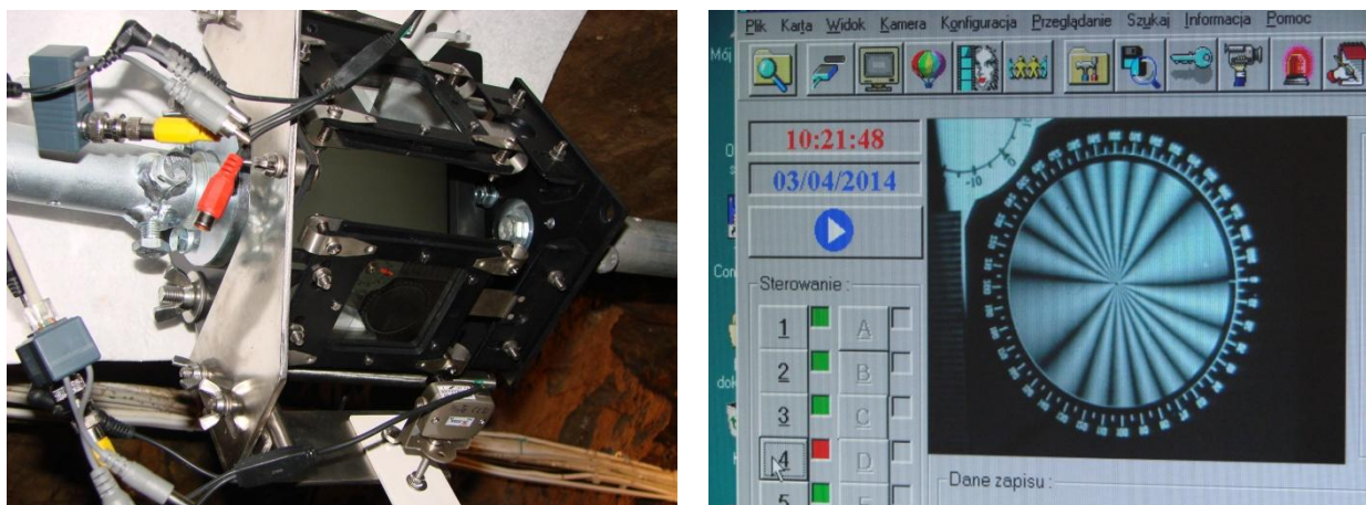
Rys. 1. Elementy elektronicznego systemu rejestracji szczelinomierza TM-71 (po lewej) oraz widok wyniku zapisu w postaci pliku graficznego (po prawej) (fot. Marek Kaczorowski)
